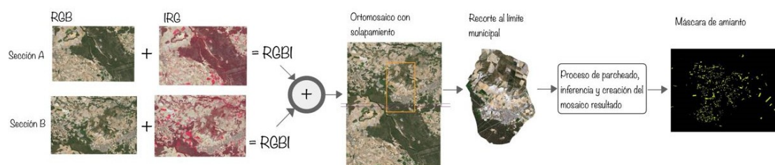
Figura 3. Esquematización de la obtención de la "máscara de amianto" a partir de imágenes satelitales. Fuente: Elaboración propia
